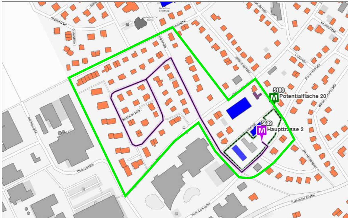
Abbildung 42: Übersicht Wärmenetz Stettiner Straße
